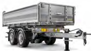
Den Humbaur Dreiseitenkipper HTK 19 t gibt es jetzt optional mit hydraulisch entriegelbarer Bordwand.
