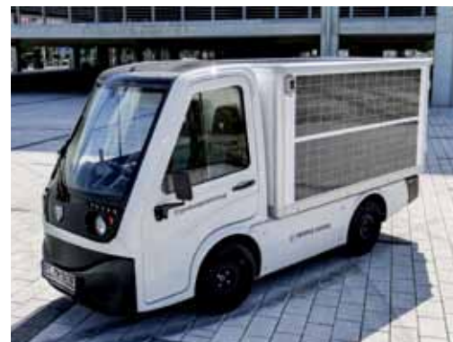
Der Elektrotransporter Tropos ABLE wird zur rollenden PV-Anlage.
