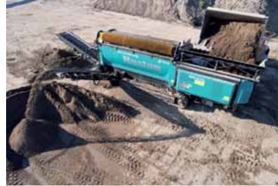
Trommelsiebzanlage MPB 20.55g von Pronar
