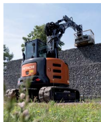
Der KTEG 63US-6 kann mit seiner großen Hubkraft selbst Lasten bis zu 2,5 Tonnen anheben – perfekt für anspruchsvolle Aufgaben im GaLaBau.
